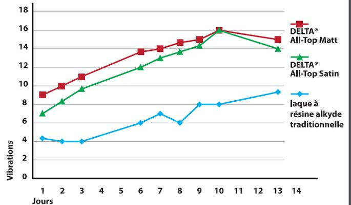
Ce mode opératoire qui détermine la dureté du film démontre que le film du produit DELTA® All-Top est plus dur
